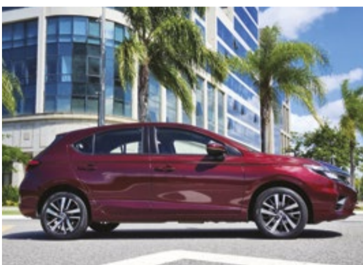
Com 4,34 m de comprimento, 1,75 m de largura, 1,50 m de altura e 2,60 m de entre-eixos, New City é o maior entre hatches compactos
