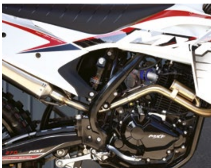
Com motor monocilíndrico de quatro tempos a gasolina de 271,3 cc refrigerado a ar, moto entrega potência de 24 cavalos
